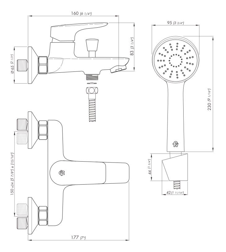
Nota: Todas las medidas están en mm y en pulgadas Note: All measurements are in millimeters and inches.
